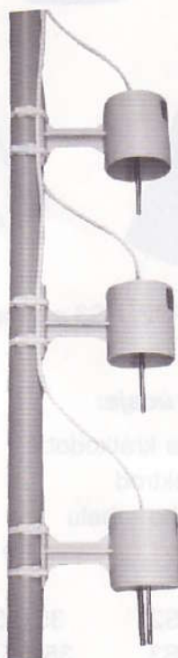
ukázka upevnění sond PSK
